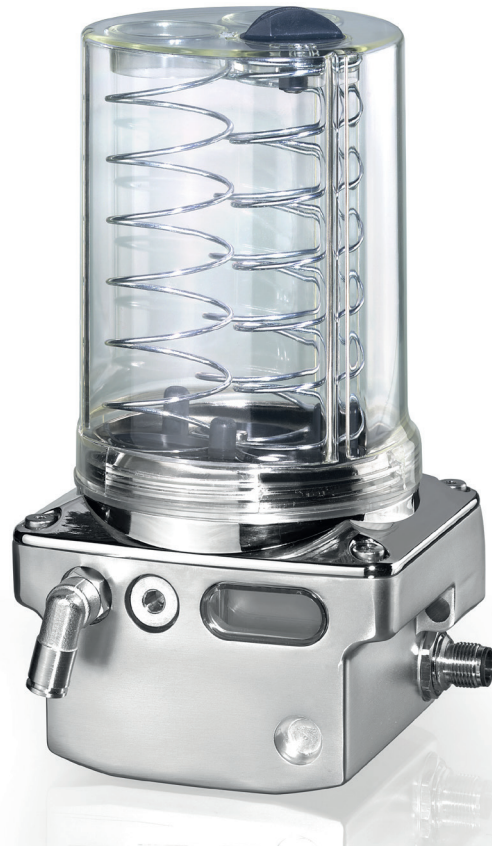
FlexxPump 401 zeitgesteuerter 24V DC Nachschmiergeber Fett; für 400 cm 3 Kartusche; Metall Gehäuse-Abdeckung; (abgebildet: 135-140-101)
